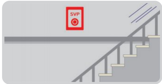
④ 스프링클러 수동조작스위치(SVP)는 피난계단 출입구 옆에 설치하세요.
