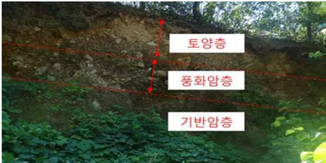
<그림 6> 토층심도 측정 방법
