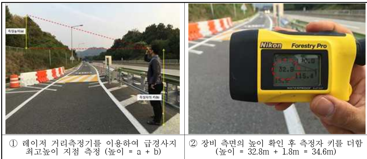
<그림 16> 레이저 거리측정기를 이용한 높이 측정
