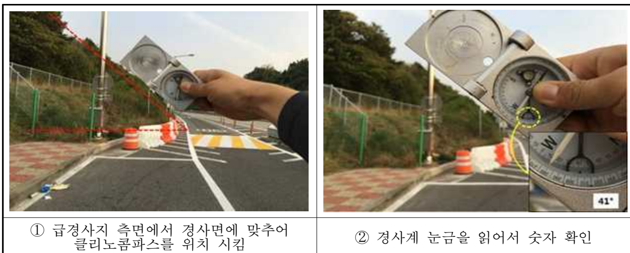
<그림 13> 측정방법 1 : 클리노콤파스 경사계 이용 방법
