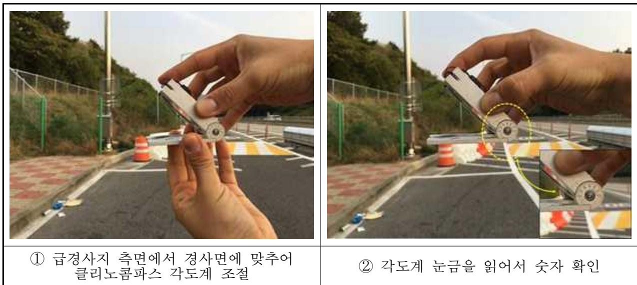
<그림 14> 측정방법 2 : 클리노콤파스 각도계 이용 방법
